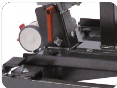
Schnellspannschraube zum werkzeuglosen Zerlegen des Lifters
