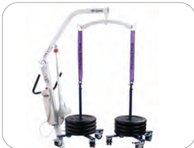
aufgehängter Zustand (Test bei einem 185 kg Lifter)
